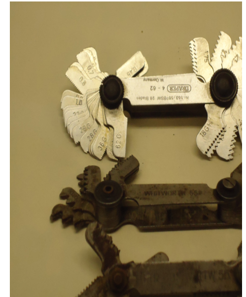
Met een draadvoeler is eenvoudig de spoed tophoek te meten
