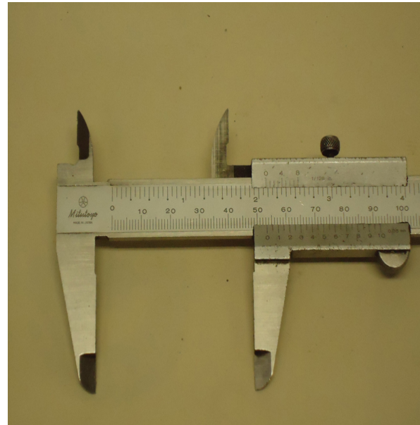
Elke normale schuifmaat heeft aan de bovenzijde een verdeling in inches.
